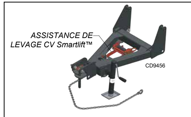
Figure 2. Raccordement de la débroussailleuse au tracteur
