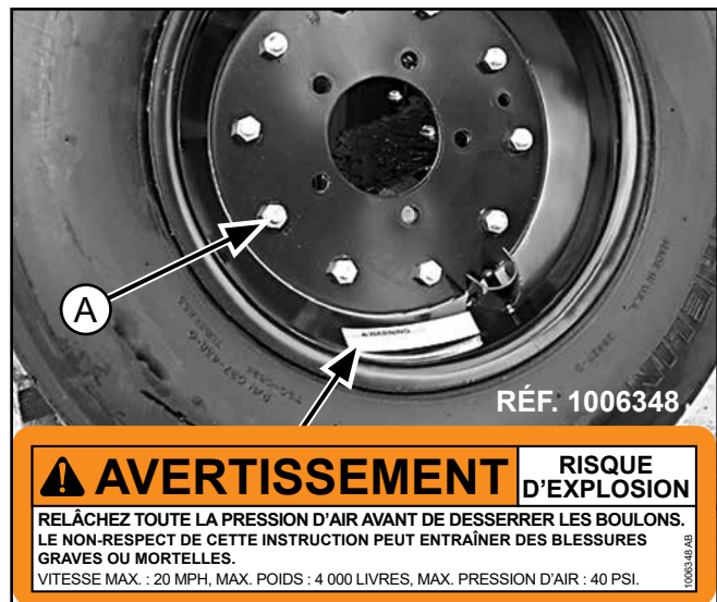
Figure 21. Entretien des pneus à jante fendue
