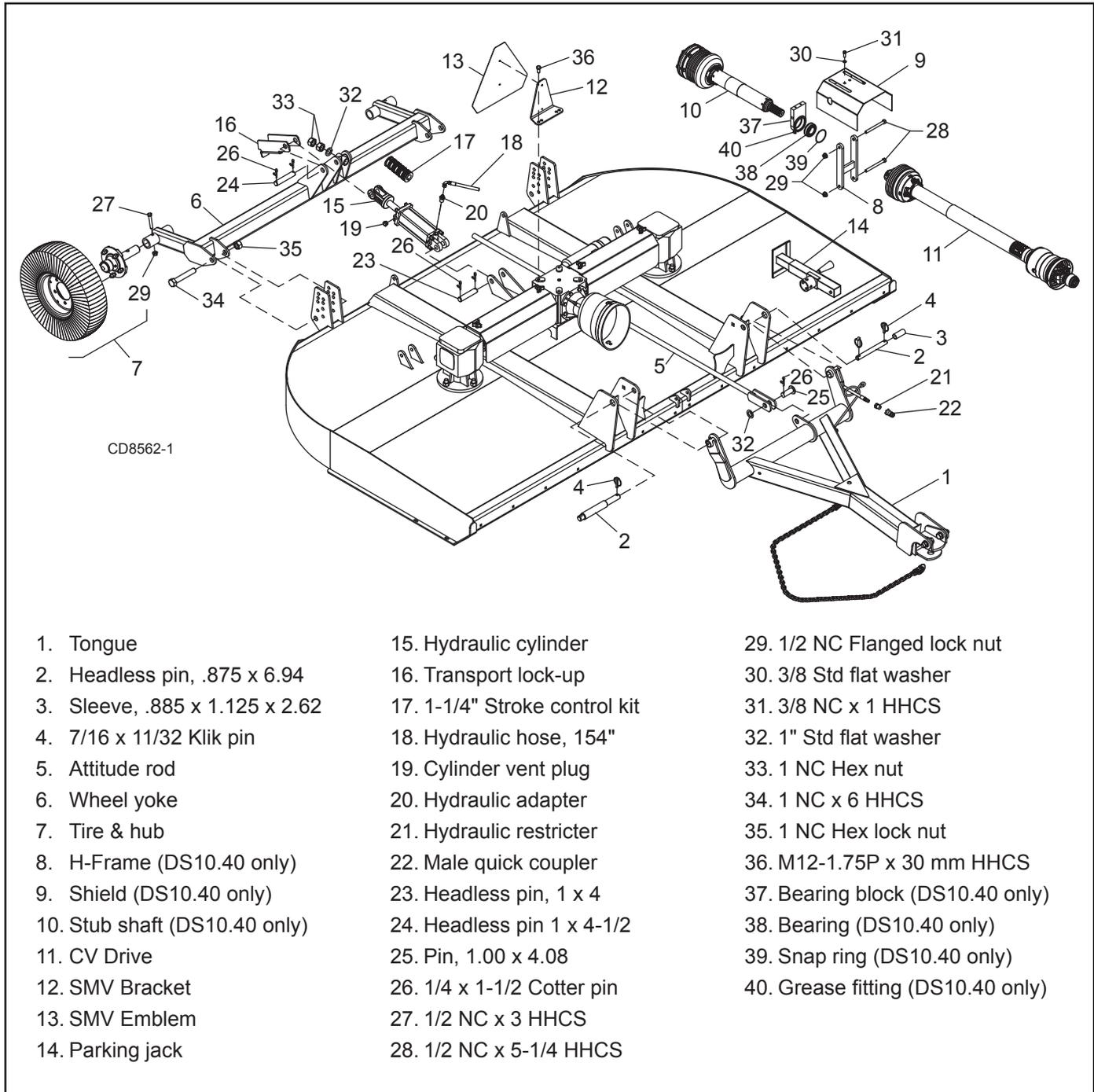
Figure 34. DS8.30 & DS10.40 Pull-Type Assembly
